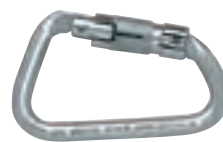
553 62 BERG KARABINER, EN 362: SZÉLESSÉG: 22 MM MINIMUM TÖRÉSI ERŐ: 20 KN
