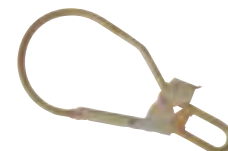
553 71 MAXI HOOK EN 362: SZÉLESSÉG: 80 MM MINIMUM TÖRÉSI ERŐ: 23 KN
