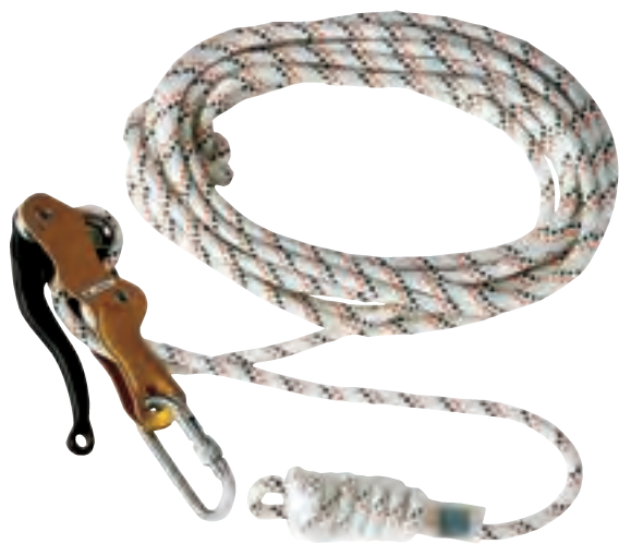
553 78 ERESZKEDŐ EN 341 CE: SÚRLÓDÓS LEERESZTŐ, 10 M KÖTÉL, AMELY FIX PONTHOZ KAPCSOLÓDIK, A HASZNÁLÓ MAGÁT ERESZTI LE, ÁLLÍTHATÓ SEBESSÉGGEL
