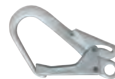
553 63 MONTBLANC HOROG EN 362: SZÉLESSÉG: 55 MM MINIMUM TÖRÉSI ERŐ: 23 KN
