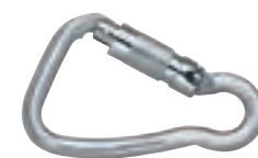
553 77 FORT KARABINER, EN 362: SZÉLESSÉG: 22,5 MM MINIMUM TÖRÉSI ERŐ: 23 KN
