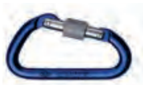
553 64 SIMPLEX KARABINER, EN 362: SZÉLESSÉG: 20 MM HÁROMSZÖGLETŰ, ALUMINIUM-KRÓM, AUTOMATA DUPLA ZÁR
