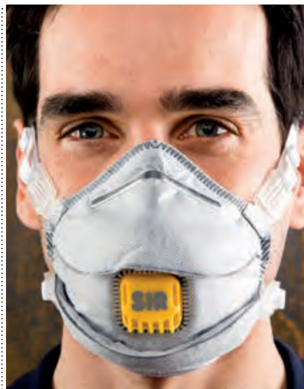
451 81 FF P2 NR EN 149: 2001+A1:2009 CE, KIFEJEZETTEN HEGESZTÉSHEZ TERVEZVE, SZÉNRETEGGEL, SZELEPPEL, TLV SZINT ALATTI POROKAT ÉS FŰSTÓKET KISZŰRI, KÖZEPESEN SZENNYEZETT KÖRNYEZETBEN AJÁNLOTT, 12X TLV, 5/DOBOZ
