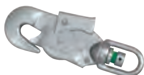
553 72 GLAM FORGÓKAPCSOS HOROG, SÚLYJELZŐVEL EN 362: A JELZŐ ZÖLD, HA NEM TÖRTÉNT ZUHANÁS, HASZNÁLATBA LÉPÉS ELŐTT VÖRÖSRE VÁLT, ÍGY FIGYELMEZTET SZÉLESSÉG: 11,5 MM MINIMUM TÖRÉSI ERŐ: 23 KN
